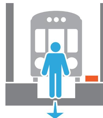
Идите вдоль полотна между рельсами, не прикасаясь к токоведущим шинам (сбоку от рельсов), во избежание поражения электрическим током
