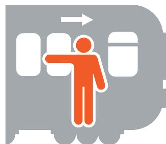
Опасно прикасаться к металлическому корпусу вагона и дверям до отключения высокого напряжения по всему участку
